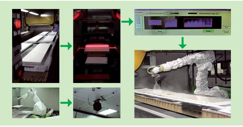
IMPIANTO CON DOPPIO ROBOT SU NASTRO DI CARTA CON MOVIMENTO CONTINUO, GRANDI QUANTITÀ DI PRODOTTO DEPOSITATO E ALTISSIMA QUALITÀ DI FINITURA, CAMBIO COLORE E LAVAGGIO PISTOLA AUTOMATICO.
