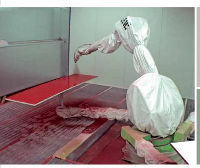
ROBOT CON GIOSTRA A TRE POSIZIONI, I PEZZI VENGONO CARICATI IN ZONA SI-CURA E PORTATI DI FRONTE PER LA VERNICIATURA, MISURE MAX 2000X900 MM. IMPIANTO ESTREMAMENTE COMPATTO, PUÒ ESSERE UTILIZZATO CON SISTEMI DI VISIONE O PROGRAMMATO MANUALMENTE CON IL MOBIL PANEL OPZIONALE.
