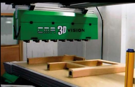
**IT** Sistema di auto generazione dei programmi di verniciatura dei robot, per mezzo di sistemi di visione artificiale che generano una immagine 2D o 3D le quali vengono processate dal software del Robot in modo da eliminare la fase lunga e laboriosa di programmazione.
