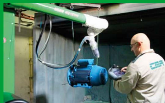
**IT** Per la programmazione detta Punto a Punto (PTP) è necessario memorizzare tutti i punti del programma per mezzo di un Mobil Panel in modo da creare le traiettorie del ciclo ed impostare tutti i parametri utili alla verniciatura finale. È anche possibile l'acquisizione dei punti muovendo manualmente il robot. Durante questo processo il robot viene messo fuori produzione per la programmazione ed il test del programma eseguito.
